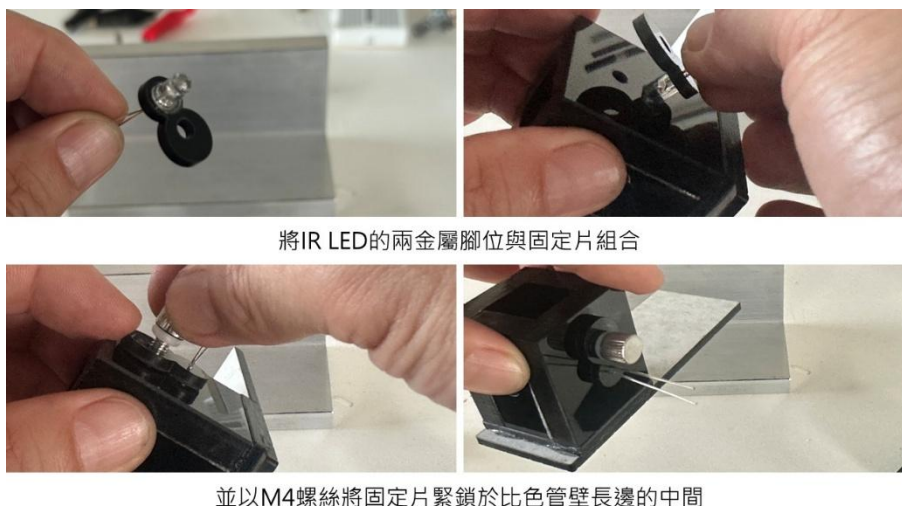
圖 7 紅外光接收二極體 IR LED 的安裝過程
