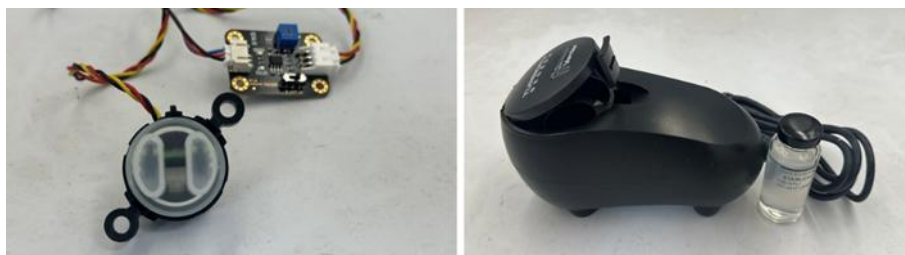
圖 2 圖左為 arduino 用濁度感測器，圖右為 Vernier 商用濁度計
